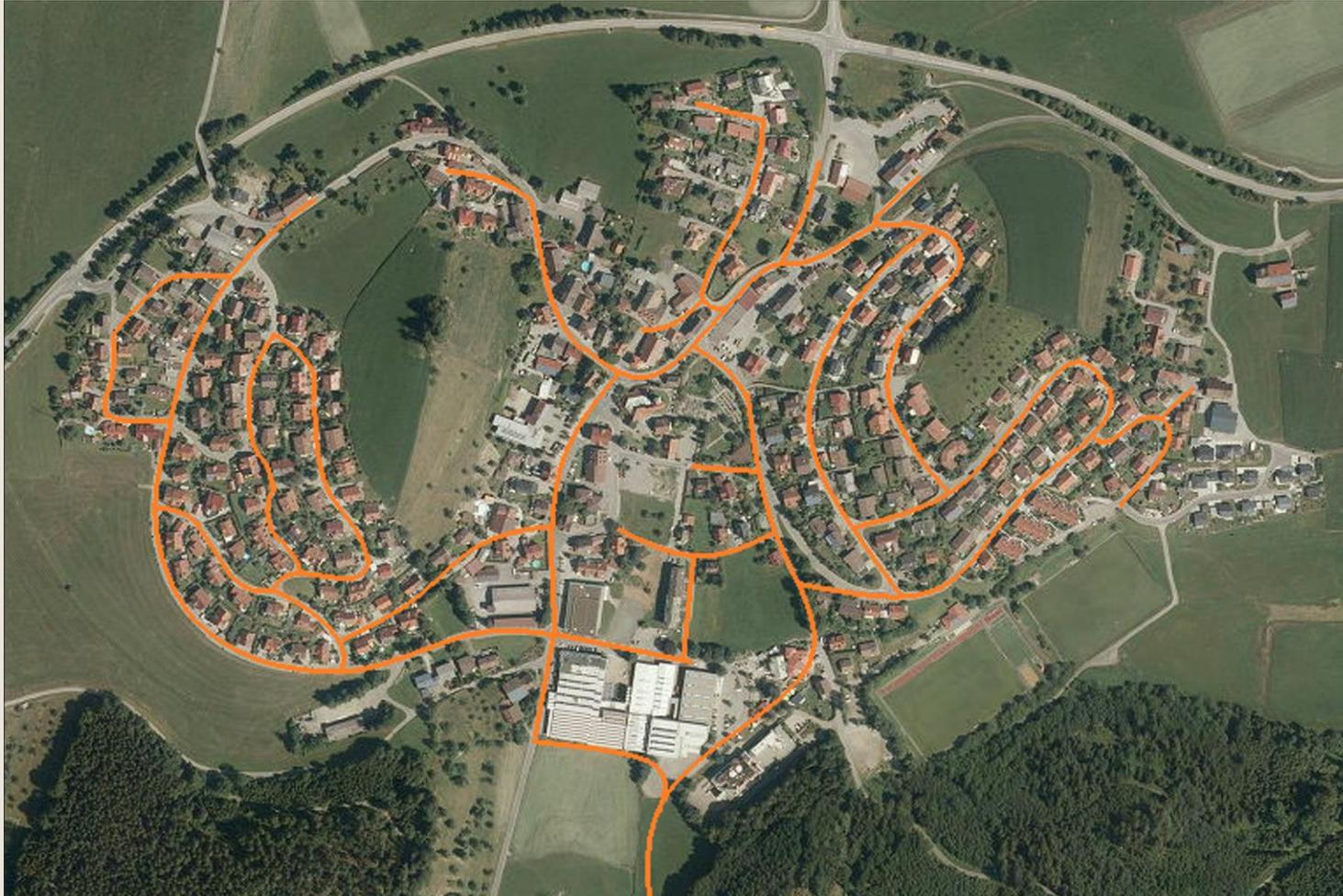
**Der Rohrnetzplan wurde auf Basis der eingesendeten Erhebungsbogen erstellt.**
